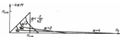
Фиг. 4: Зависимост на намагнитването от магнитното поле за различни стойности на \kappa .
