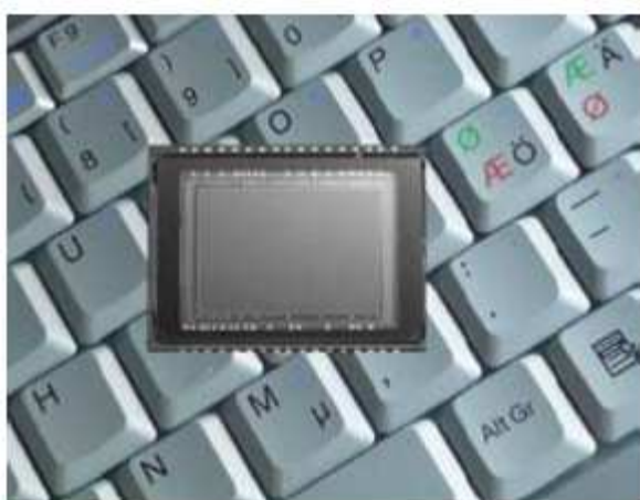
Фиг. 6: Чип на една много мегапикселова CCD камера.
