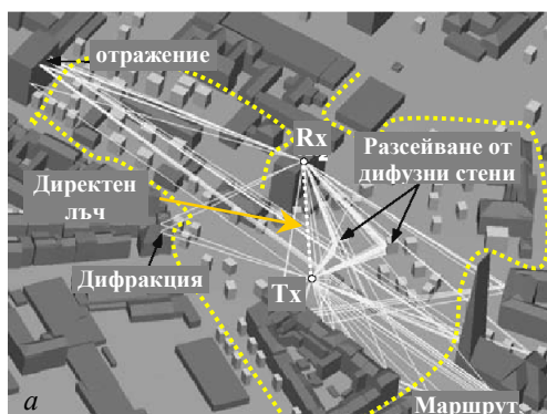
Фиг. 13. Сравнение на резултатите са затихване от 3D модел лъчево трасиране, емпиричен модел и измерване
