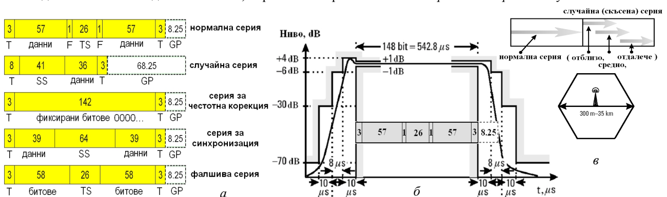
Фиг. 31 а) Типове серии в GSM мрежата: нормална серия (за трафични канали в двете посоки); случайна серия (за достъп на потребителите в даден времеинтервал); серия за честотна корекция и за синхронизация (само в downlink канала); фалшива серия (замества нормалната при отсъствие на потребители в даден времеинтервал); б) Структура на нивото на сигнала по време на всяка излъчвана серия (на този фон е показана е продължителността на нормалната серията); в) скъсена серия
