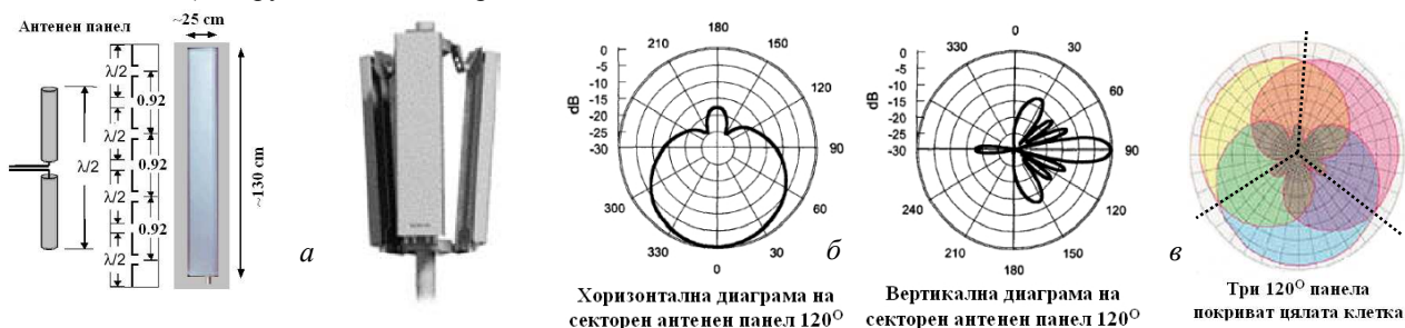
Фиг. 44. Антени за базови станции: а) единичен панел и тройка панели с наклон 5-15^\circ ; б) хоризонтална и вертикална диаграма на насоченост на отделен панел; в) хоризонтални диаграми на тройка антенни сектори
