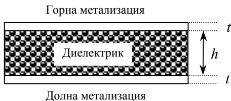
Фиг. Д1.1 Диелектрична подложка с двустранна метализация
