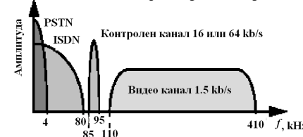
Честотен спектър на 1.5 Mbit/s ADSL сигнал заедно с традиционните сигнали във фиксираната мрежа
