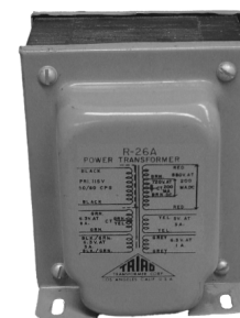
Универсален мрежов трансформатор
