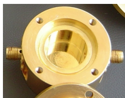
Обемни метални резонатори: отразящи от вълноводи
