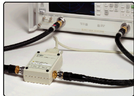
Елементи за механична калибровка на входовете на анализатор на вериги
