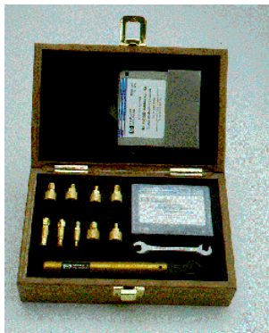
Елементи за механична калибровка на входовете на анализатор на вериги
