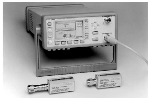
За средна и импулсна мощност с вградена памет и сменяеми датчици
