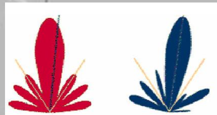
Остронасочена антена с адаптивен (въртящ се) лъч
