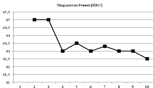
Фиг. 8. Твърдост на материала в зависимост от приложената обработка
