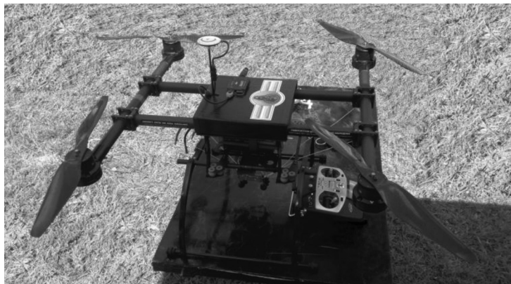
Фиг. 2. Квадрокоптер с обща подемна сила на четирите ротора около 100 N [18], притежание на Университетския център за въздушно наблюдение към СУ
