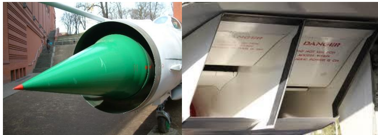
Фиг 2 Входните устройства на МиГ-21 (вляво) и на Concorde (вдясно)
