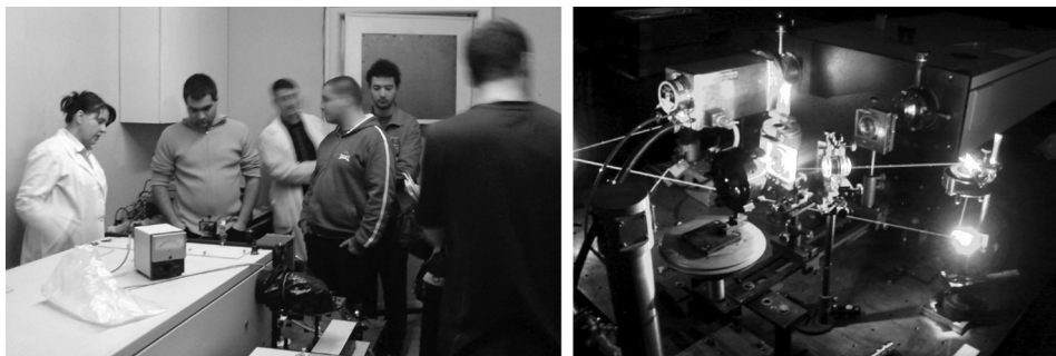
Студентско упражнение в Лабораторията по електронни и фононни свойства за изследване на фотолуминесценция на твърдотелни материали при ниски температури до 10 К и апаратурата по време на работа (вдясно)
