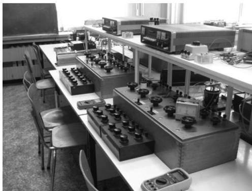
Работни места за упражнението „Електрични измервания по компенсационен метод“ в практикума по електричество и магнетизъм
