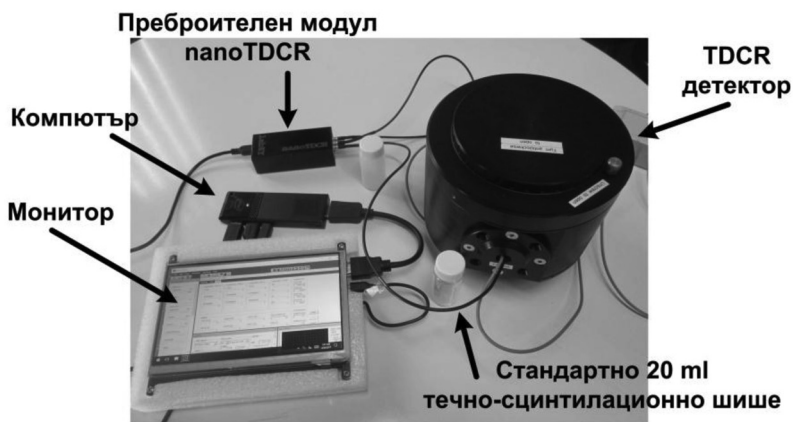
Фиг. 3. Снимка на детекторната система TDCR-SU. За мащаб в центъра са поставени две стандартни 20-милилитрови течно-сцинтилационни шишета
