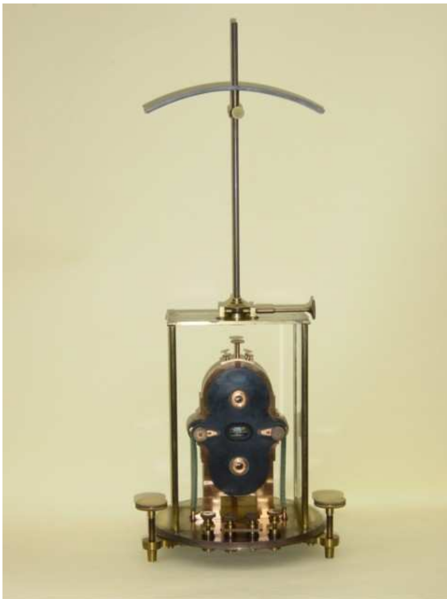
Прочутият огледален галванометър на У. Томсън
