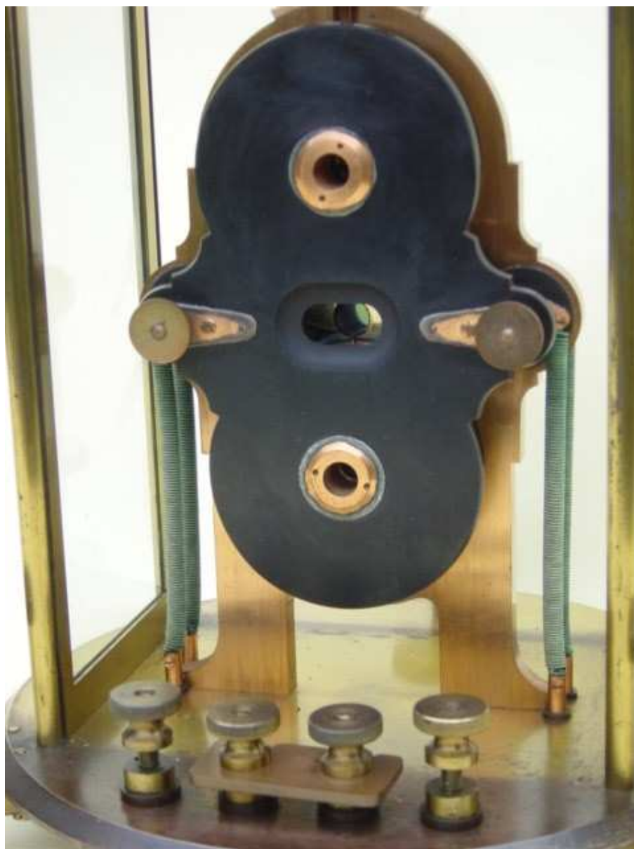
Намотките и огледалото вътре в галванометъра на Томсън
